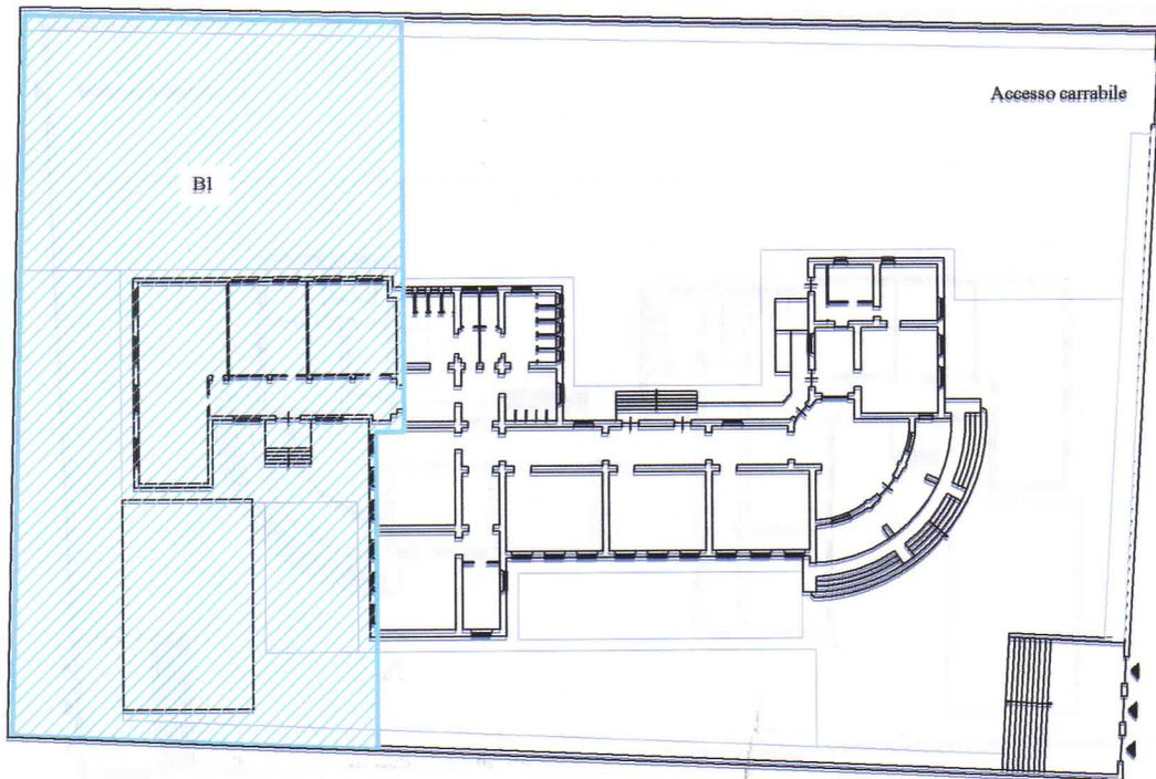
Le lavorazioni previste per il blocco 1 riguardano essenzialmente la sostituzione degli infissi, tinteggiature interne ed esterne, la realizzazione della pavimentazione, rifacimento tinteggiatura parapetti terrazzi ed interventi prettamente strutturali consistenti nell'incamiciatura dei pilastri essendo questa porzione di fabbricato in cemento armato.
