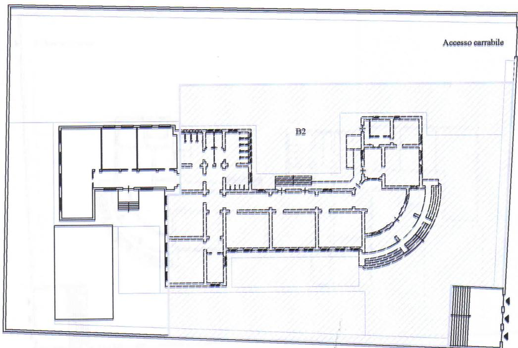
Le lavorazioni previste per il blocco 2 riguardano essenzialmente nello smontaggio e rimontaggio degli infissi, tinteggiature interne, nella sostituzione dei battiscopa, nella realizzazione di zoccolatura perimetrale, rifacimento tinteggiatura parapetti terrazzi ed interventi prettamente strutturali consistenti nella realizzazione di intonaco armato sulle pareti in muratura portante.
